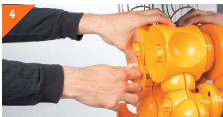
4 Démontez le couteau en tirant vers soi, grâce à l'espace laissé au doigt. ATTENTION! Le couteau peut couper.
