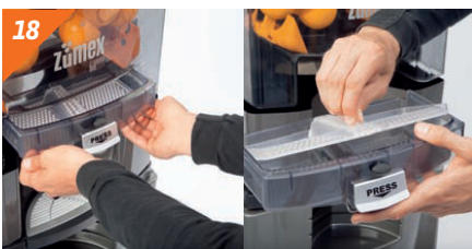
18 Replacer le filtre et réservoir.
