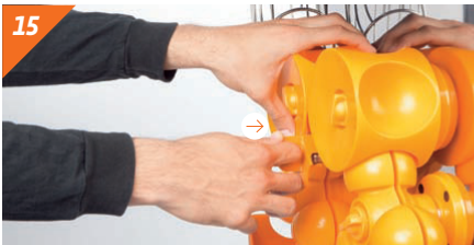
15 Insérer le couteau de nouveau: appuyer jusqu'à entendre le clic.
