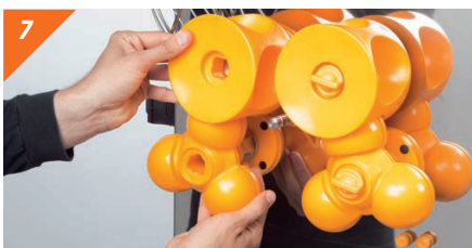
7 Démontez les tambours par couple (tambour male + tambour femelle).
