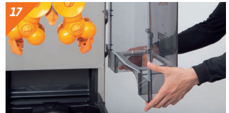
17 Remettre en place le capot.
