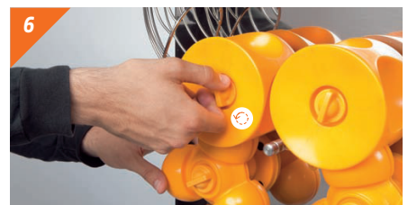
6 Dévissez les axes fixateurs des tambours du système de pressage.
