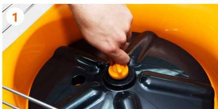
1 Démontez le **plateau chargeur** en dévissant le pommeau central et nettoyez ensuite la base du chargeur avec un chiffon humide.
