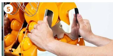
5 Insérez l'ensemble du kit d'extraction dans les axes de fixation.
